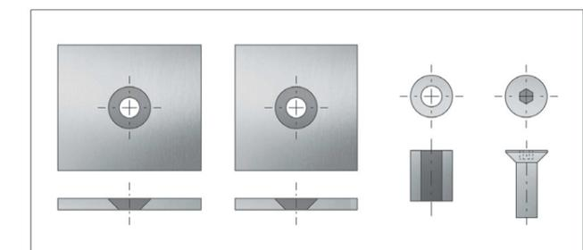
Rondelle A   Rondelle B   Insert   Vis
